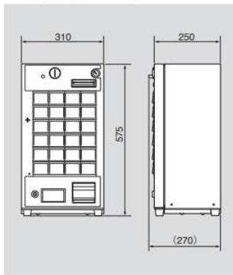
■設置寸法図 (単位: mm)
